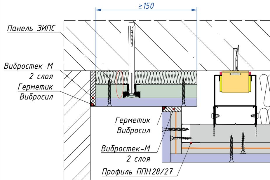
Принципиальная схема устройства
