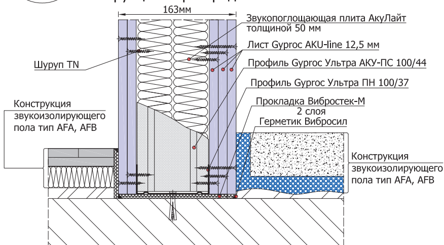
1.28.3 Примыкание звукоизолирующих облицовок стен к конструкции перегородки
