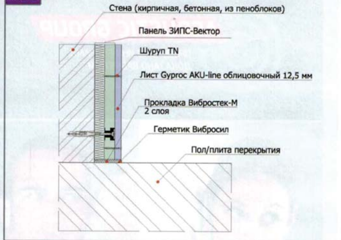
СХЕМА ЗИПС, СМОНТИРОВАННОЙ НА СТЕНЕ
