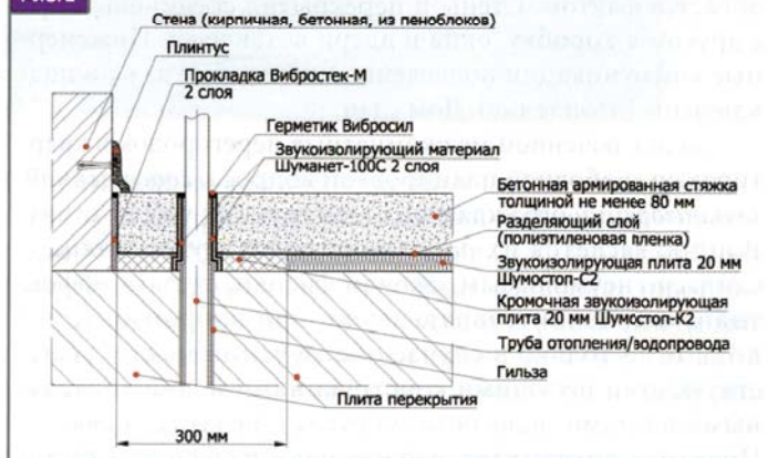
СХЕМА УСТРОЙСТВА «ПЛАВАЮЩЕГО» ПОЛА ДЛЯ ИЗОЛЯЦИИ УДАРНОГО ШУМА
