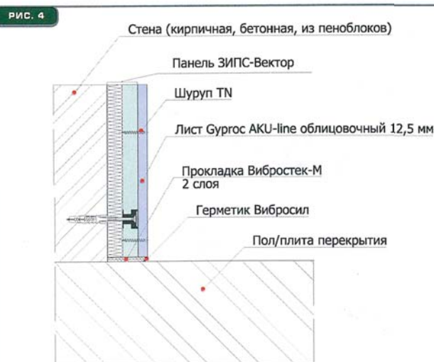
СХЕМА ПАНЕЛЬНОЙ СИСТЕМЫ «ЗИПС», СМОНТИРОВАННОЙ НА СТЕНЕ
