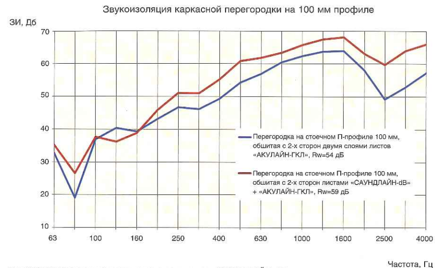
Рис. 2 Звукоизоляция акустического триплекса «САУНДЛАЙН-dB»
