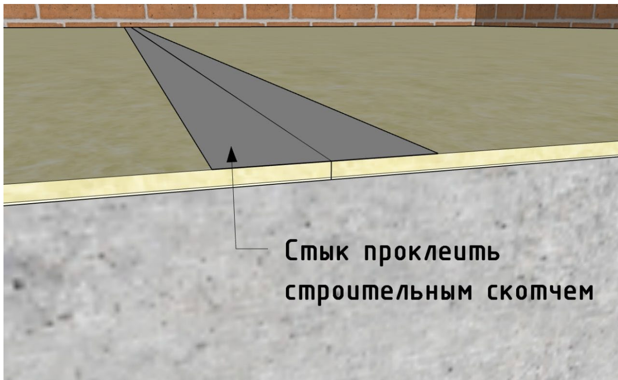
Рисунок 10. Проклейка стыка между рулонами Акуфлекс-Супер.
