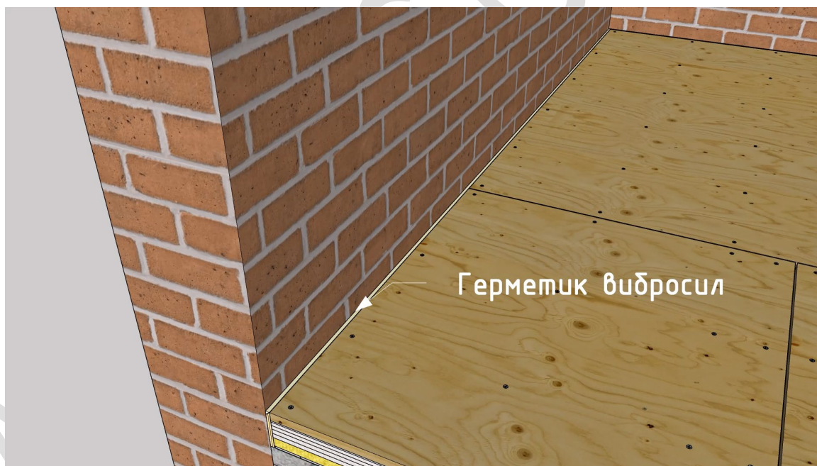
Рисунок 20. Заполнение шва герметиком Вибросил.
