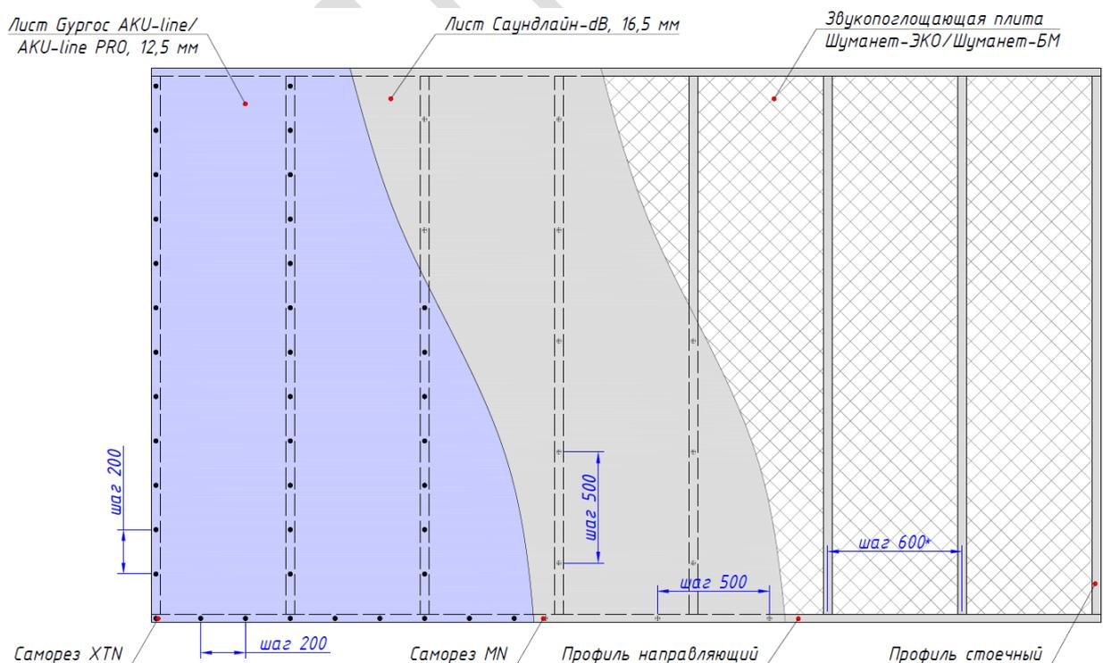
Рисунок 18. Конструкция звукоизоляционной каркасной облицовки.
