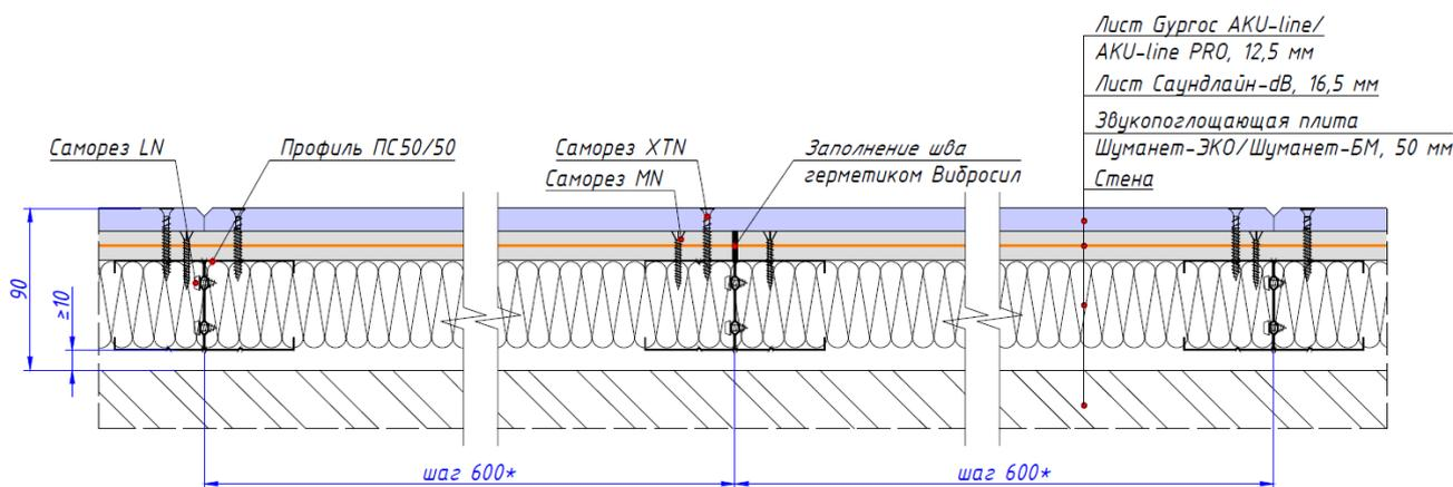
Рисунок 15. Расположение стоечных профилей в конструкции звукоизоляционной каркасной облицовки на независимом каркасе из профиля ПС 50/50 (AG.L-401).
