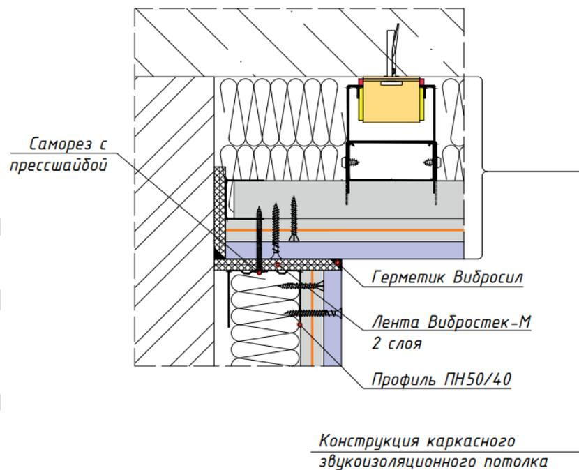
Рисунок 8. Примыкание независимой каркасной облицовки к конструкции звукоизоляционного потолка.
