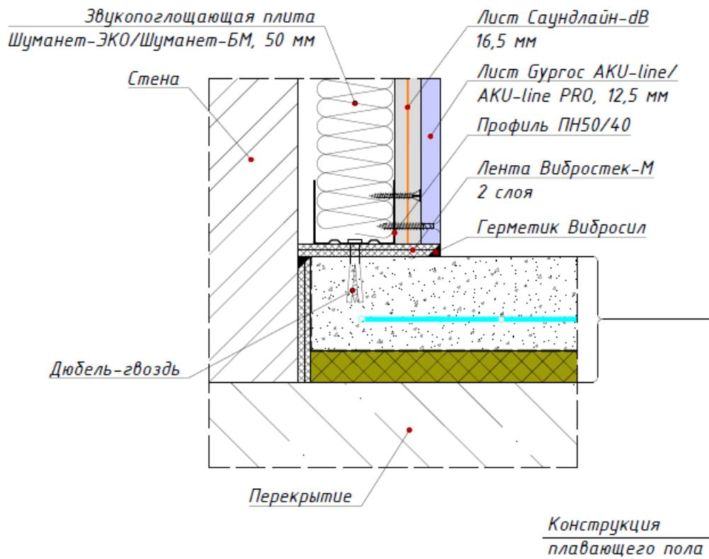
Рисунок 7. Примыкание облицовки стены на независимом каркасе 50 мм к конструкции плавающего пола.
