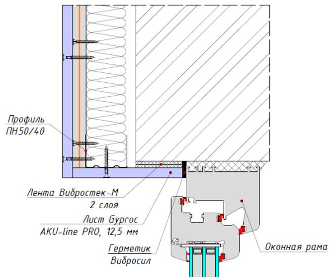
Рисунок 11. Оформление верхнего горизонтального оконного откоса при устройстве независимой каркасной облицовки.
