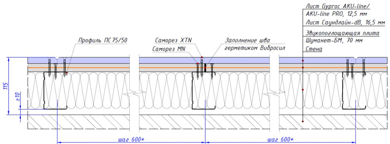
Рисунок 3. Конструкция независимой каркасной облицовки на профиле ПС 75/50 (AG.L-402).
