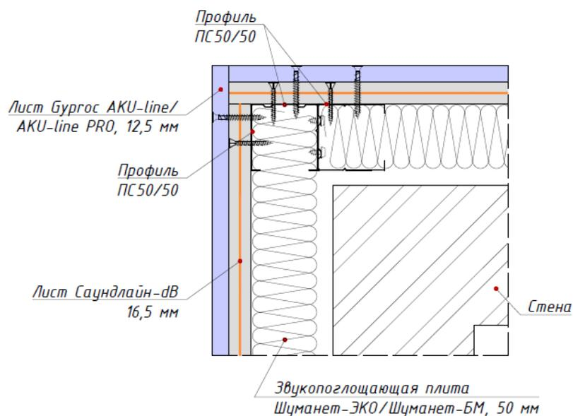
Рисунок 6. Оформление внешнего угла в конструкции независимой каркасной облицовки.
