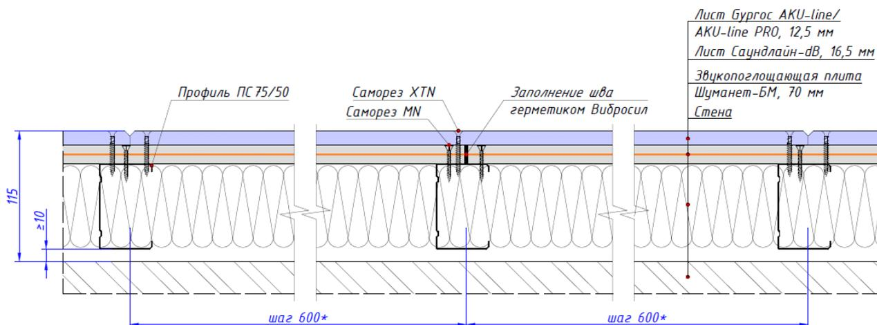
Рисунок 14. Расположение стоечных профилей в конструкции звукоизоляционной каркасной облицовки на независимом каркасе.
