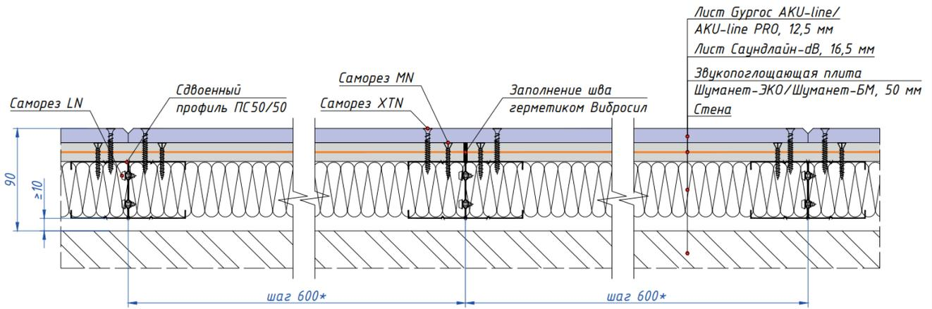
Рисунок 2. Конструкция независимой каркасной облицовки на сдвоенном профиле ПС 50/50 (AG.L-401).
