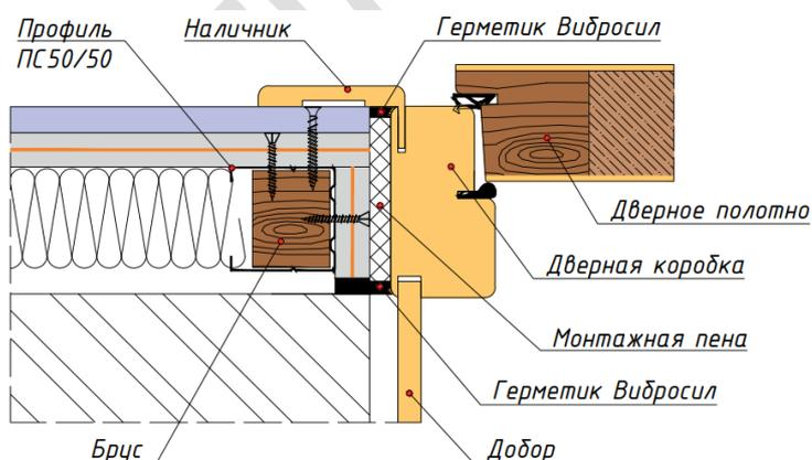
Рисунок 16. Оформление дверного проема в конструкции звукоизоляционной каркасной облицовки на независимом каркасе.
