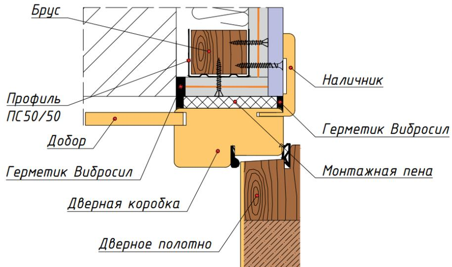
Рисунок 10. Оформление горизонтального дверного откоса.
