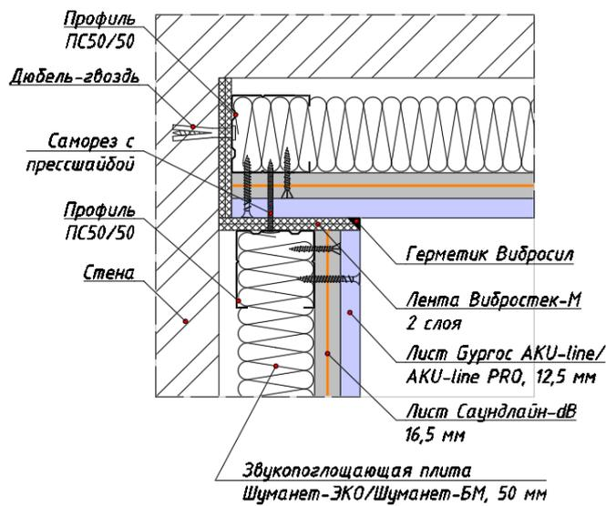
Рисунок 5. Оформление внутреннего угла в конструкции независимой каркасной облицовки.
