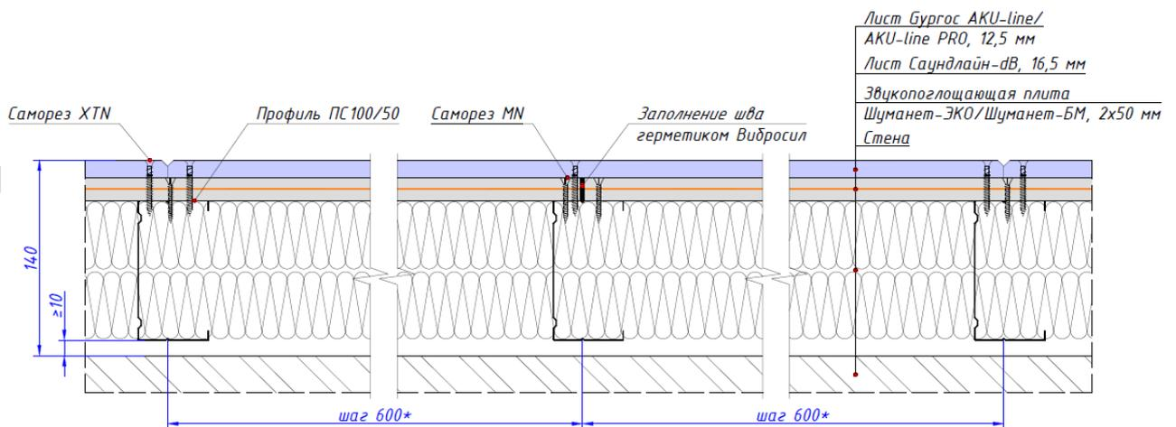
Рисунок 4. Конструкция независимой каркасной облицовки на профиле ПС 100/50 (AG.L-403).
