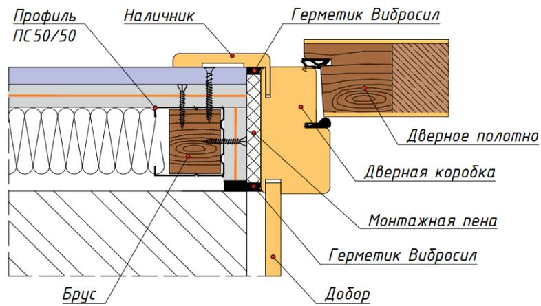
Рисунок 9. Примыкание независимой каркасной облицовки к дверной коробке.
