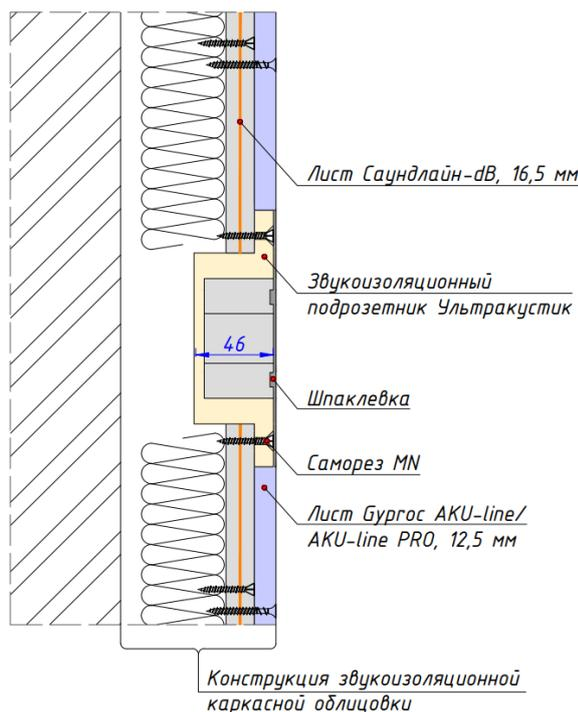
Рисунок 23. Монтаж электроустановочных изделий в каркасных звукоизоляционных конструкциях облицовок при помощи звукоизоляционных подрозетников Ультракустик.
