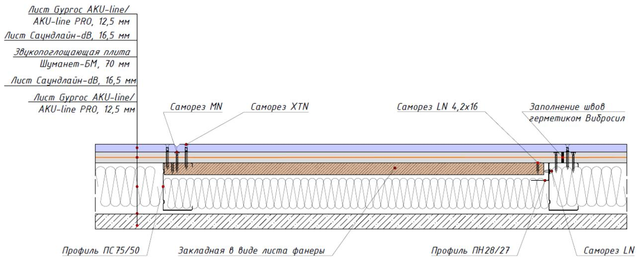
Рисунок 17. Устройство закладных элементов в звукоизоляционной каркасной облицовке на независимом каркасе.
