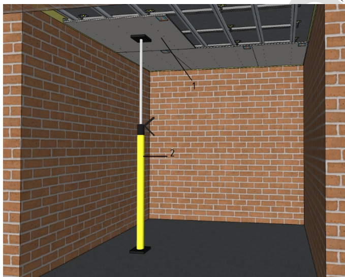
Рисунок 12. Установка листов акустического триплекса Саундлайн-dB в проектное положение. 1 – акустический триплекс Саундлайн-dB; 2 – телескопический подъемник.
